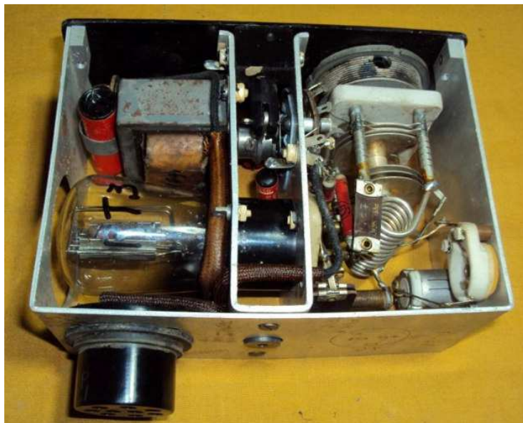
Vista interna in evidenza la valvola ed il trasformatore di modulazione
